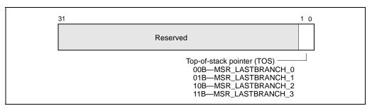
Figure 14-4. MSR\_LASTBRANCH\_TOS MSR Layout
